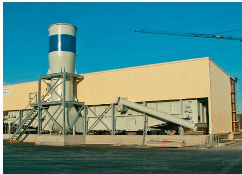
In Krauchenwies setzt man auf einen Bandrockner mit 120 m 2 : die Trockenspanproduktion beträgt 5,5 t/h
